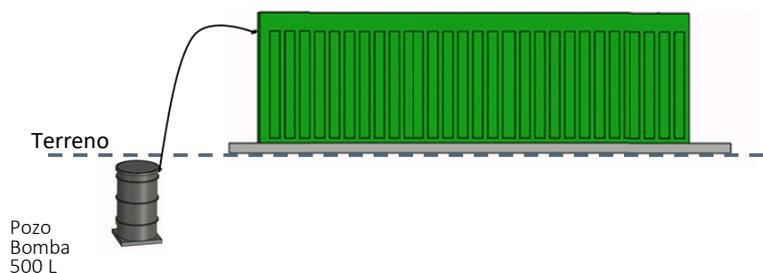
El BioContenedor "Combi IB" debe ser colocado en una superficie nivelada horizontalmente con una variación máxima de + 0 - 1 cm por 4 metros. La superficie debe consistir en grava compactada estable o en una losa de hormigón de 200 mm construida sobre un suelo estable. La versión "Combi IB" cuenta con todos los pasos de limpieza incorporados y se considera un sistema completamente transportable.
